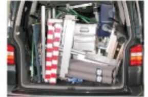
Abbildung 1: ungesicherte Beladung und eine hohe Zuladung in einem Transporter
