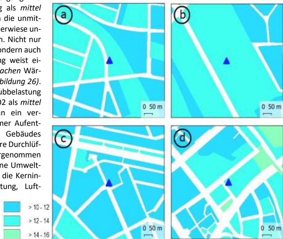
Abbildung 23: Mittlere jährliche Anzahl der Hitzetage (T max ≥ 30°C) für den Zeitraum 2011-2040 an den Einrichtungen WfbM 1 (a), WfbM 2 (b), BGZ (c) und KJA/SPZ (d).
